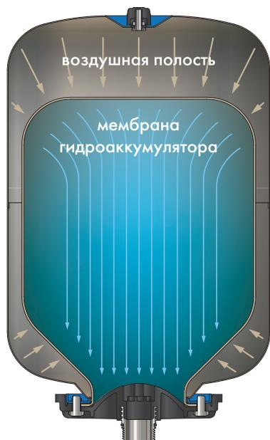
В исходном состоянии в гидроаккумулятор через воздушный клапан (ниппель) закачан воздух до давления 1,5 бар.
